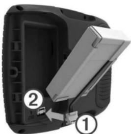
5 Zatvorte kryt batérie a upevnite D-krúžok krytu batérie.
